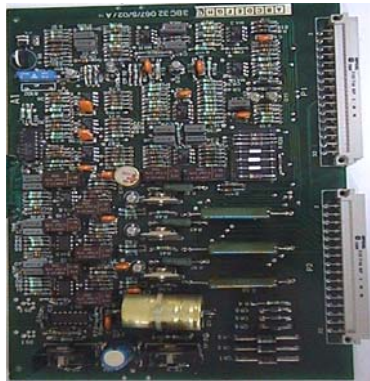
Gambar 1.30 Rangkaian elektronik AVR
